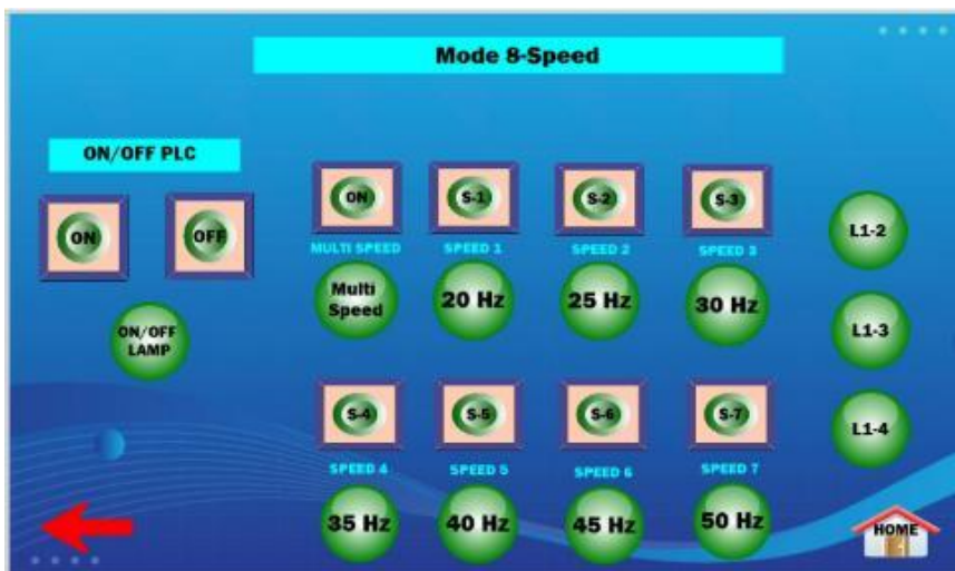
Gambar 3. Display HMI Mode Pemilihan Kecepatan 8-Speed
