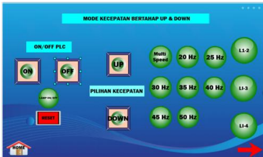
Gambar 2. Display HMI Mode Kecepatan Bertahap Up/Down
