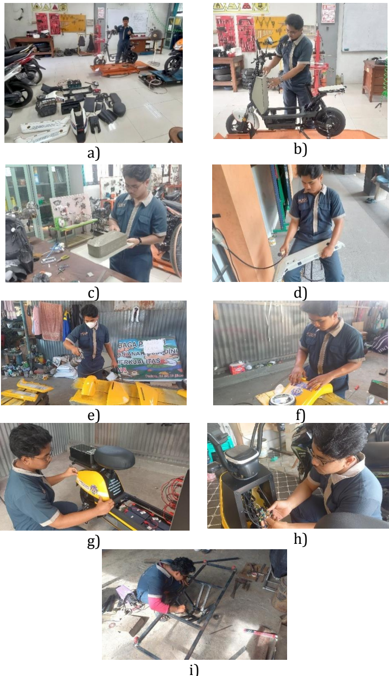
Gambar 2. Langkah-langkah produksi sepeda listrik dan pembuatan Bracket , a) Pembongkaran seluruh bodi sepeda listrik, b) Pembuatan panel kelistrik dari fiberglass , c) Pembuatan kotak controller dari fiberglass , d) Pembuatan panel akrilik (transparan), e) Pengecatan bodi sepeda listrik, f) Pemasangan stiker pada bodi sepeda listrik, g) Pemasangan seluruh bodi sepeda listrik, h) Pemasangan panel kelistrikan, i) Proses pembuatan Bracket
