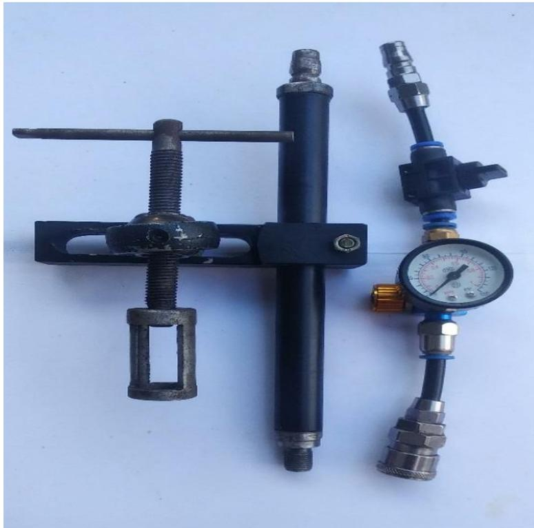
Gambar 6. Hasil Rancang Bangun SST Pembuka Pegas Katup Berbasis Pneumatik
