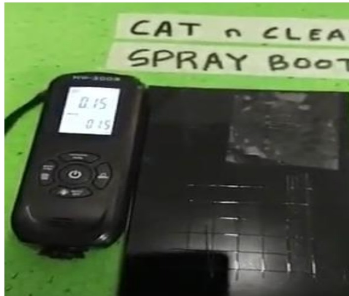
Gambar 3. Hasil Thickness Tester Pada Spray Booth .
