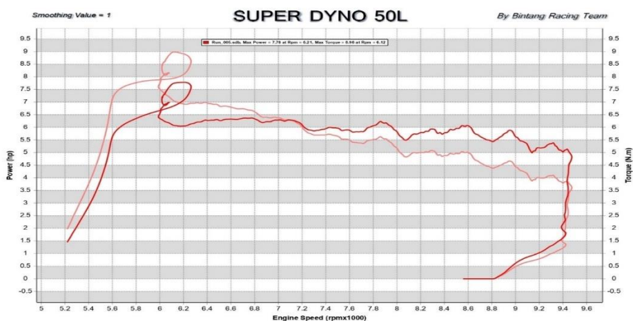
Gambar 5. Grafik hasil uji torsi dan daya yang dipasang Turbo Cyclone JSC.
