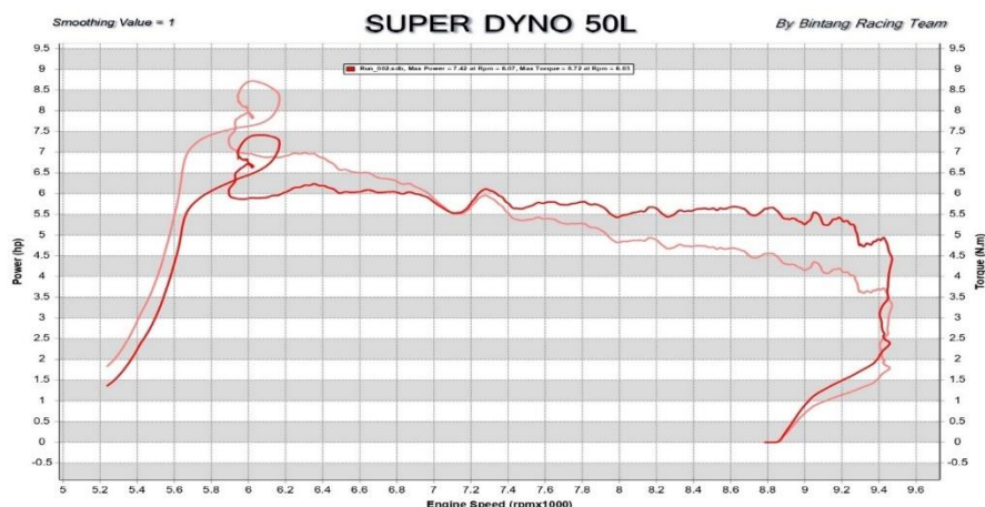
Gambar 4. Grafik hasil uji torsi dan daya yang dipasang Turbo Cyclone Jet Ranger
