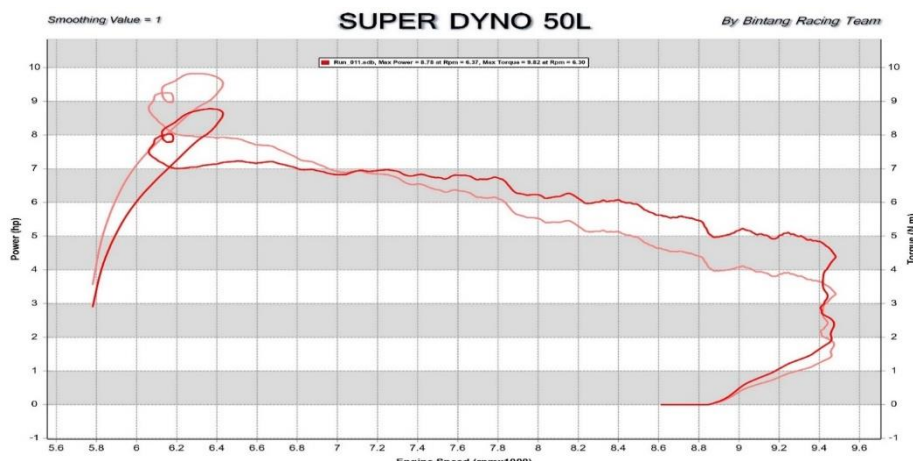
Gambar 3. Grafik hasil uji torsi dan daya tanpa Turbo Cyclone
